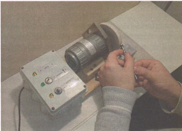
Рисунок 4 – Заточка сверла на спроектированном станке
